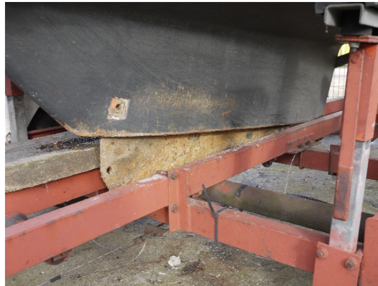
8- L'axe étant retiré la dérive n'est plus maintenue: on lève le bateau pour la dégager
